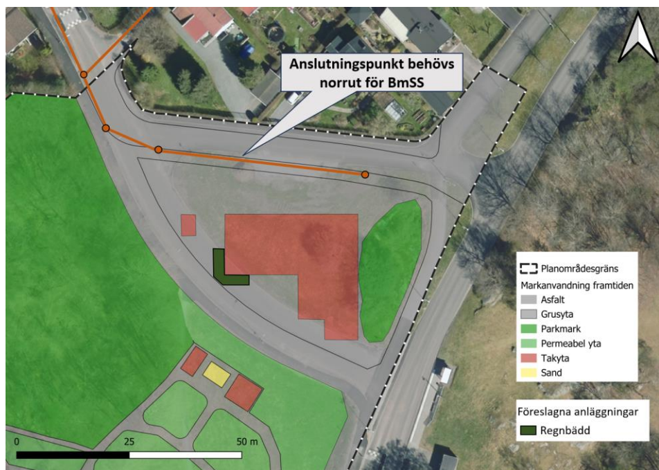
Figur 27 Föreslagen dagvatten- och skyfallshantering för norra delen av planen.
