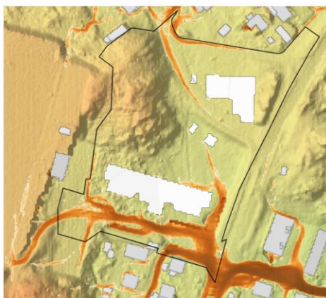
Figur 25 Jämförelse av flödesvägar (ytvattenflöde) mellan nuläge och framtida exploatering (med framtida byggnader och justeringar i markmodellen i sydöstra hörnet). (Källa ScalgoDynamic)
